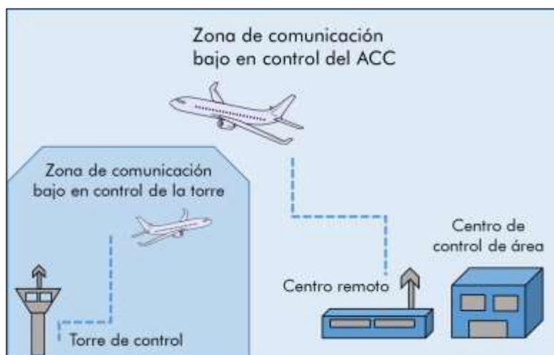
Figura 2. Esquema Sistema de comunicaciones (centros de emisión y recepción) para la aeronavegación y operación en un Aeropuerto
